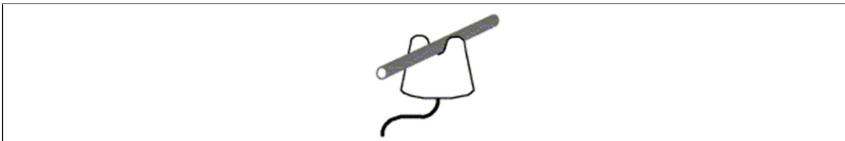
Figuur 5.24. Plaatsingswijzen van elektrische leidingen – Op isolatoren
